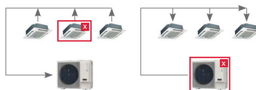
Automatische afpompfunctie waarbij het koudemiddel, bij servicewerkzaamheden, naar keuze naar keuze in de buitenunit of in de binneneenheden kan worden opgeslagen
